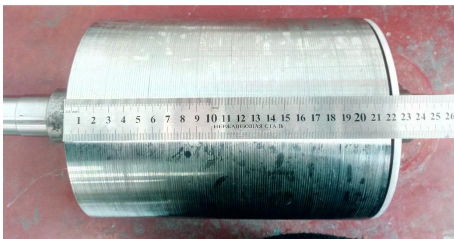
Рисунок 3.7. Ротор в сборе
