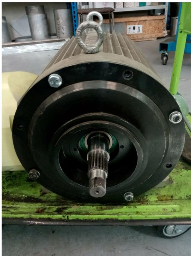
Рисунок 2.22. Тяговый двигатель (опытный образец)
