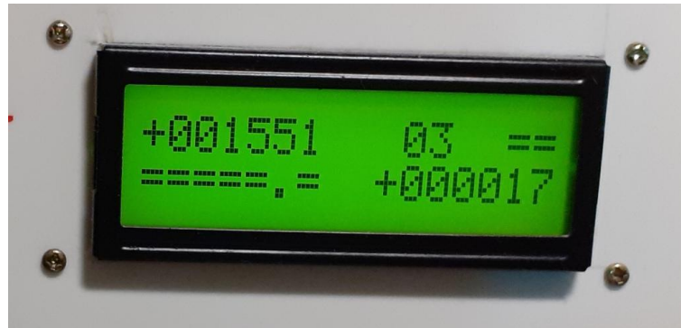
Рисунок 4.22 — Дисплей в рабочем режиме при отсутствии повреждения
