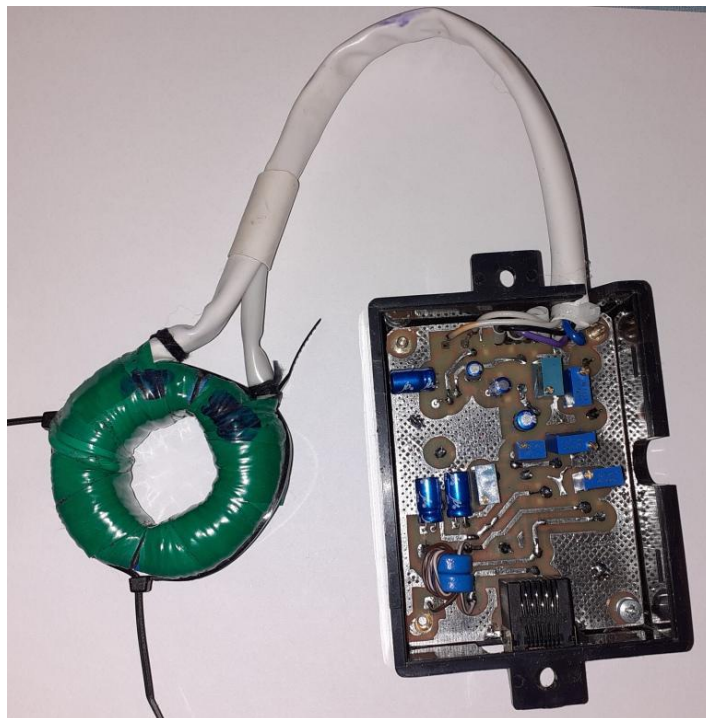
Рисунок 4.26 — Вид внешнего усилителя и разъемного датчика тока
