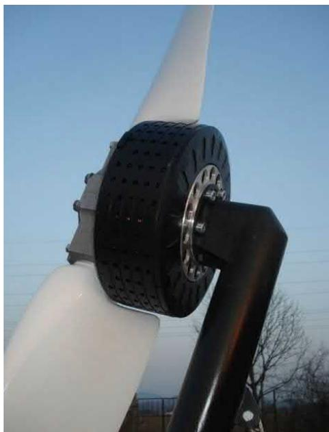
Рисунок 1.9 – Дисковый электродвигатель *Emrax*
