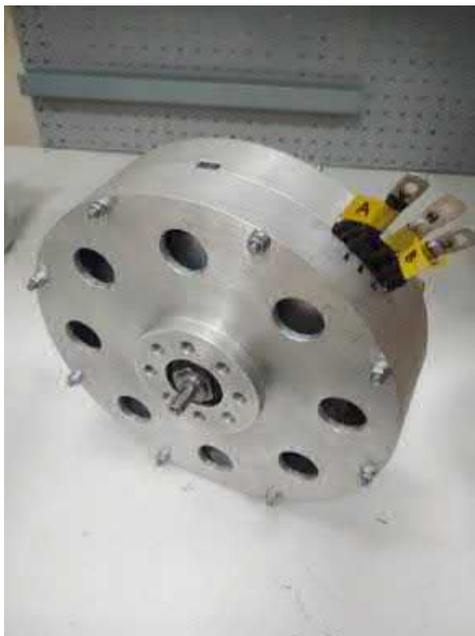
Рисунок 5.13 – Экспериментальный образец дискового двигателя
