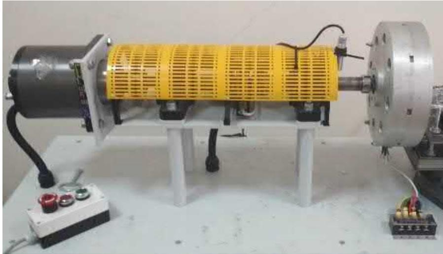
Рисунок 5.14 – Экспериментальная установка с дисковым двигателем
