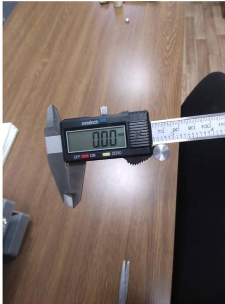
Рисунок 4.3 а – Вид цифрового штангенциркуля ШЦЦ-1-300
