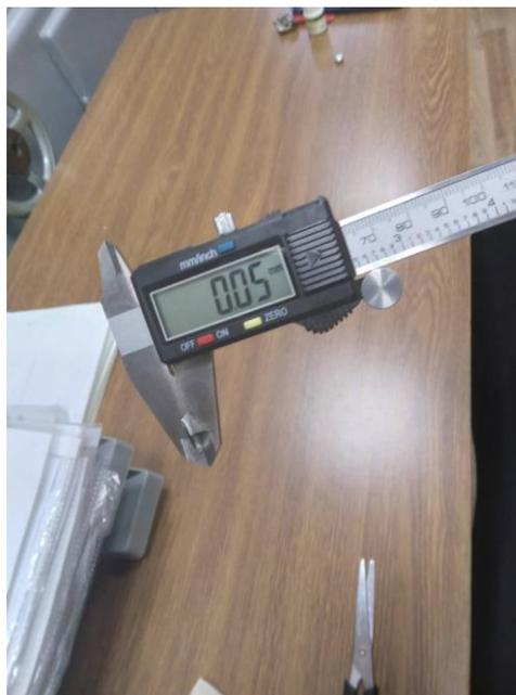
Рисунок 4.3 б – Замер толщины алюминиевой фольги, необходимой для постановки эксперимента
