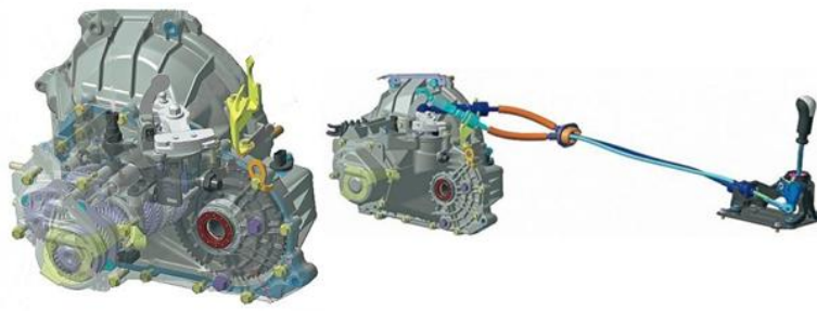
Рисунок 4.12 – Коробка переключения передач с тросовым приводом.
