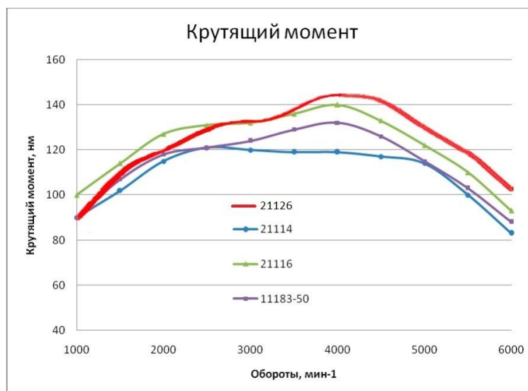
Рисунок 2.8 – Сравнение зависимостей крутящего момента двигателей семейства автомобилей ВАЗ
