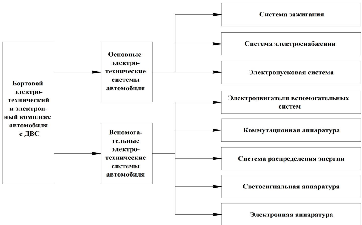
Рисунок 1.7 – Классификация систем бортового электрооборудования автомобиля
