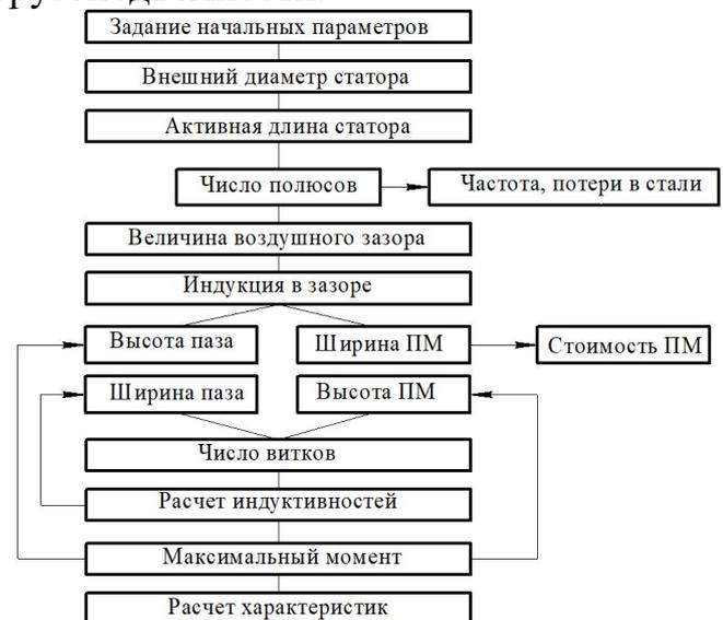
Рисунок 3. Алгоритм проектирования ТЭД по максимуму момента
