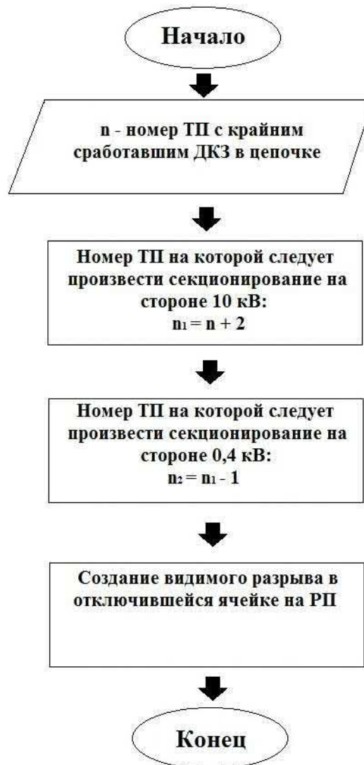
Рисунок 21 – Алгоритм переключений при МКЗ между РП и ТП
